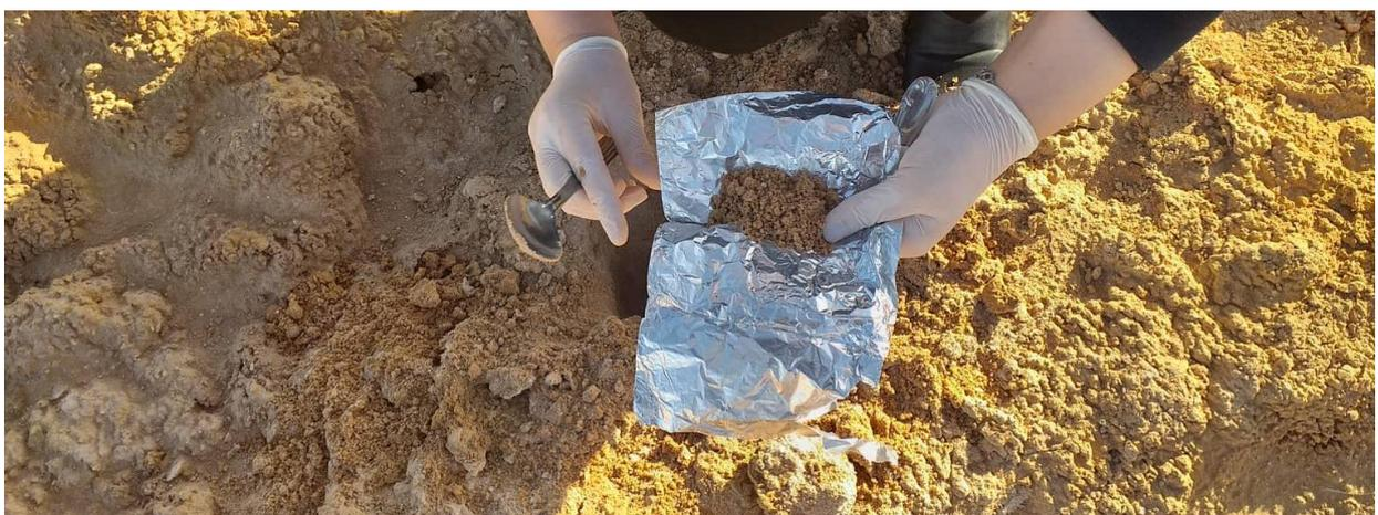
**Figure 6:** Le dépôt de l'échantillon sur la feuille d'aluminium stérile.
